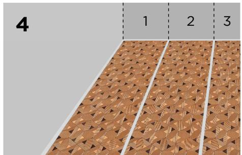
Разложите панели на полу вдоль стены на которую планируется монтаж для проверки правильности замеров.
