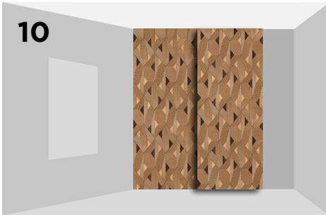
Устанавливаем следующие панели по заранее подобранному варианту раппорта рисунка. При установке используем монтажный клей HD1000, а при монтаже на стены с деревянным покрытием или обрешеткой с помощью пневмопистолета и строительных шпилек.
