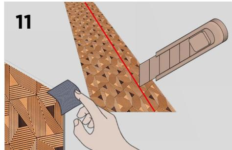
При необходимости реза панели вдоль длины можно использовать распиловочный стол или канцелярский нож и строительное правило. Обрезанный край можно откорректировать с помощью мелкозернистой наждачной бумаги.
