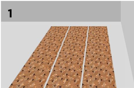
Перед монтажом панели необходимо вытащить из упаковки, разместить на ровной поверхности и дать им отлежаться в помещении, где планируется монтаж в течение 48 часов.
