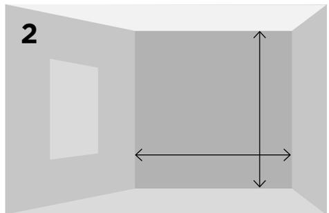
Проведите необходимые замеры поверхности на которой планируется монтаж панели. При замере необходимо учитывать размеры плинтуса, карниза и других декоративных элементов.
