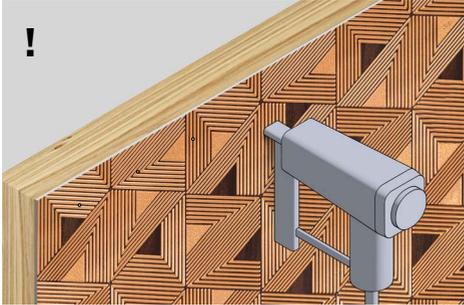
При монтаже на стены с деревянным покрытием или обрешеткой возможна установка с помощью пневмопистолета и строительных шпилек
